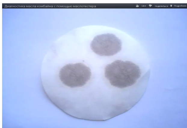
Рис. 2. Капельный анализ пробы на фильтровальной бумаге
